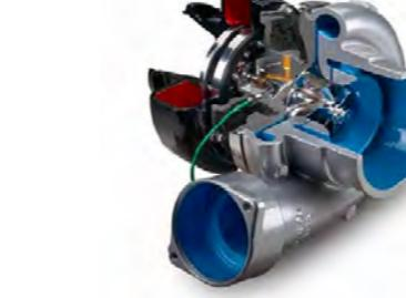
VNT (Variable Nozzle Turbo) adalah teknologi turbo modern yang beroperasi secara variabel dengan kontrol elektrikal membuat pembakaran optimal.
